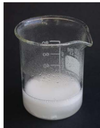
Reacción entre el carbonato de sodio y el ácido clorhídrico.
