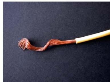
El cobre conduce, el plástico no
