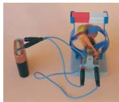
Una reacción química en la pila permite que exista una corriente eléctrica, y el paso de ésta por la bobina bajo la influencia del imán produce el movimiento del motor.
