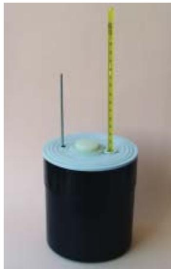
El calorímetro es un sistema aislado
