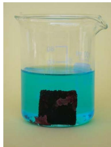
Reacción redox entre el sulfato de cobre (II) y el cinc. Se produce cobre sólido sobre la lámina de cinc.
